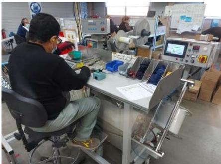
Le travailleur prend un gobelet à gauche et met 3 écrous et 3 rondelles dans le gobelet. Il le pose ensuite dans un bac placé à sa droite
